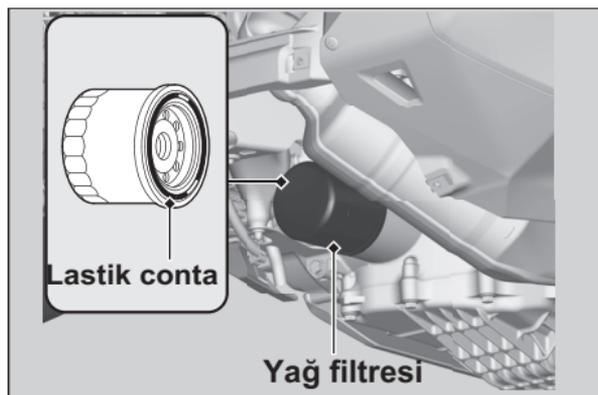
7. Filtre anahtarı ile yağ filtresini söküp kalan yağın boşalmasını sağlayınız. Önceki contanın motora sıkışmadığından emin olunuz.
